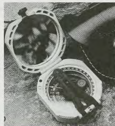
Дорогий компас ($200!!) фірми Brunton стабілізує стрілку через індукцію.
