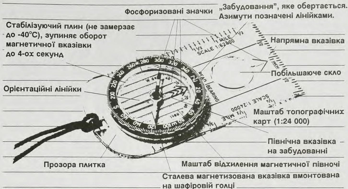
Частини звичайного компаса (Silva Explorer III Type 3) з деякими „додатками” (див. текст)
